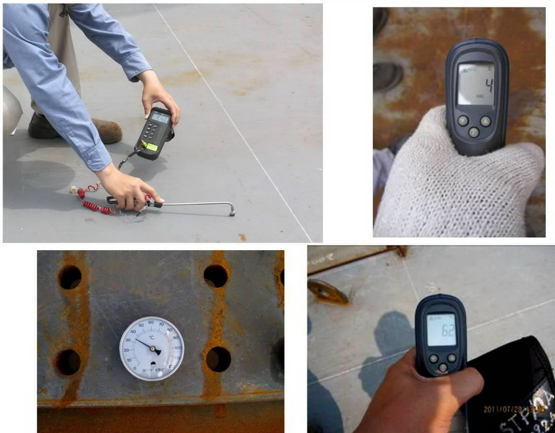
照片 35 預裝構件溫度量測
