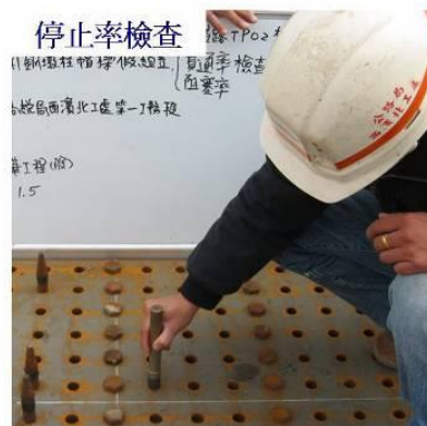
照片 31 螺栓孔貫通率及阻塞率檢查
