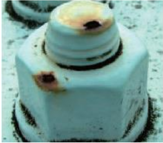
(a) 銹蝕現象從斷裂面毛邊先出現
