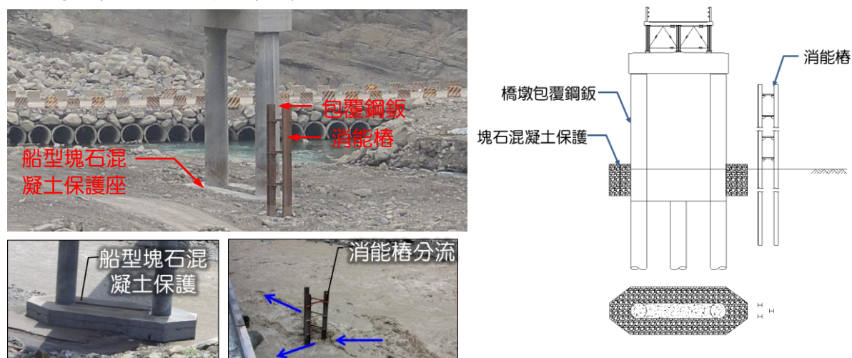
圖 15 橋墩耐撞擊能力設計示意圖
